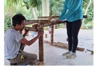
Posicione o bambu com a barra roscada na lateral e alinhe o bambu superior para marcar a altura do furo, considerando que a altura das laterais é de 84 cm.
