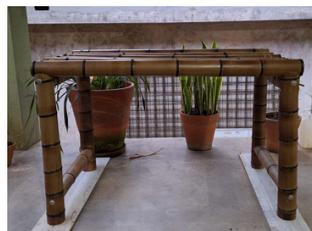
Após a amarração, utilize uma lixadeira para remover o excesso de bambu nas laterais.
