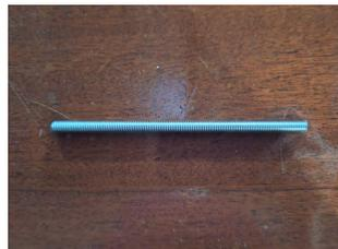
Corte 4 peças de barra rosca de 5/16 com 14 cm de comprimento.
