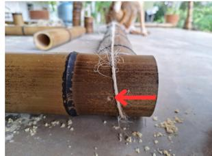
Em ambas as extremidades, use uma broca para realizar um furo atravessando o bambu de cima para baixo, alinhado aproximadamente com o meio da perna, permitindo a entrada da barra rosca 5/16.
