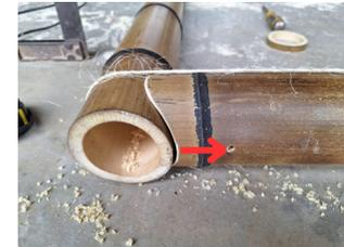
Use uma broca para fazer um furo atravessando o bambu na parte lateral da perna, permitindo a entrada da barra rosca 5/16. Meça 4 cm da cava e perfure nesse ponto. Repita o processo na outra perna.
