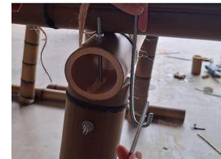
Em ambas as extremidades, fixe o gancho na parte superior e uma peça de 14 cm na lateral, alinhando-os de forma que o gancho se encaixe na barra para realizar um travamento. Coloque arruela e porca nas pontas.
