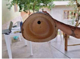
Utilize uma broca ou a própria barra roscada para fazer um furo na parte superior, permitindo a passagem da barra roscada 3/8. Perfure a parte superior do bambu, atravessando-o de ponta a ponta.
