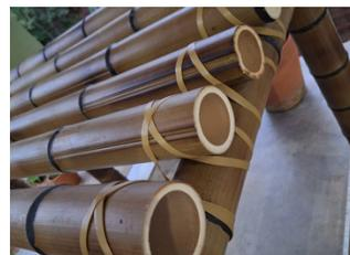
Em seguida, utilize câmara de pneu ou cipó sintético para fixá-los com firmeza, garantindo que os bambus fiquem bem presos e que o tampo permaneça estável e seguro.
