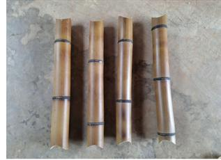
Corte 4 peças de 70 cm e faça a boca de peixe, com 4,5 cm de profundidade, nas duas extremidades de cada peça, para as laterais da mesa.
