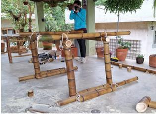
Amarre as duas estruturas reservadas com os bambus extras, de forma que a mesa fique com 80 cm de largura e 1,30 m de comprimento.
