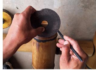
Use um disco de 10 cm para marcar a boca de peixe no bambu, posicionando-o 3 cm acima do nó se houver.
