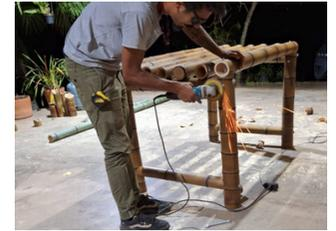
Utilize uma lixadeira para realizar o acabamento final, removendo as sobras da barra e deixando-a bem rente e lisa.
