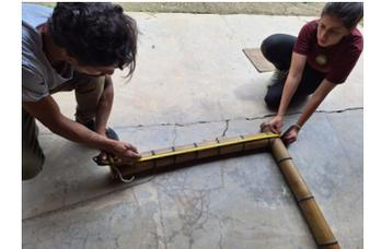
Marque a altura de 84 cm a partir da borda superior do tampo em direção à extremidade da perna. Repita o processo na outra perna.
