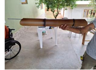
Use uma barra rosca de 3/8 x 1 metro para atravessar o bambu de ponta a ponta.
